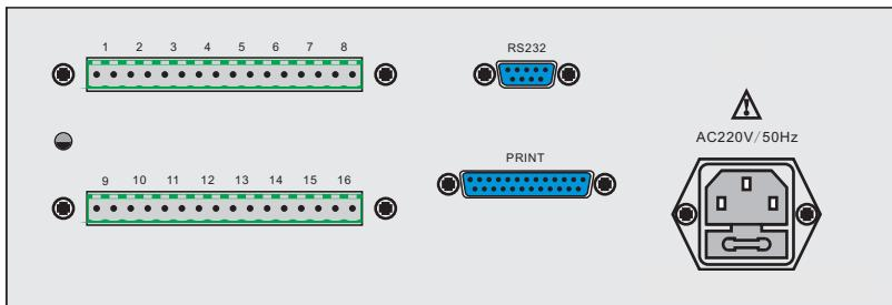
仪器的后面板由热电耦输入端, RS-232-串行口, 打印口, 电源插座, 保险管座等组成。热电耦输入1到16路, 左面接正极右面接负极。
